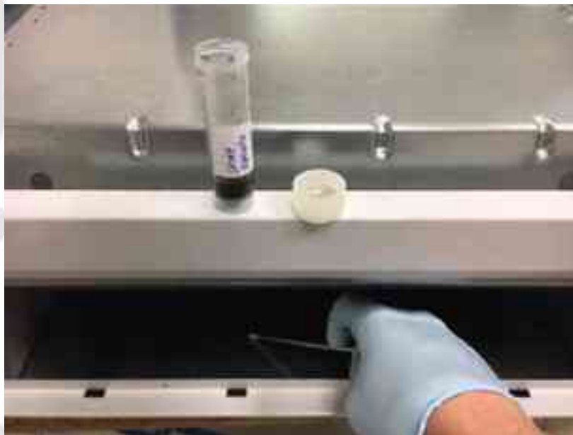
Figura 8 - contaminazione del dispositivo con spore fungine
