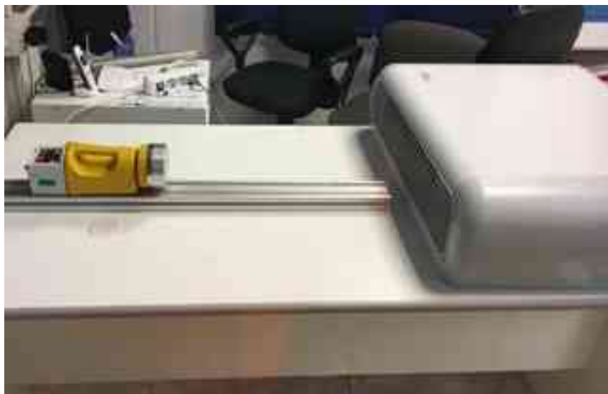
Figura 1 - prelievo di aerosol mediante SAS Super 100
