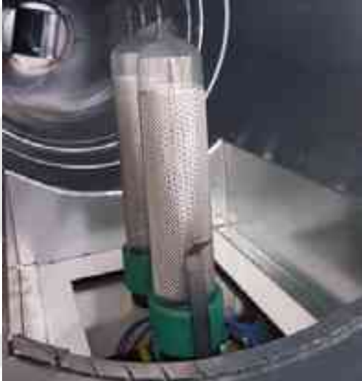
Il sistema di misura è costituito da un sistema di aspirazione dell'aria che viene portato in un sistema di generazione di plasma freddo (NTP) e successivamente in un sistema di misura.
